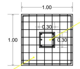
zapata aislada de concreto armado  $f_c=250$  kg/cm<sup>2</sup> de 1.00 x 1.00 x 0.15 cm de alto, armada con varilla de 1/2" @ 15 cm
